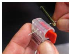
2.- Hilvane un extremo del alambre por uno de los dos orificios del precinto.
