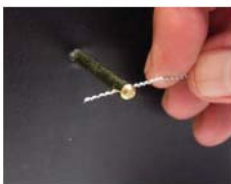
1.- Introduzca el alambre por el orificio/s del elemento/s a precintar.
